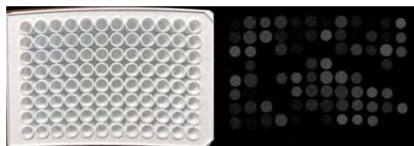
Figura 1. Ejemplo de un par de imágenes insumo-objetivo en el conjunto de entrenamiento de la red neuronal. (izquierda) imagen de la placa deformada k=60 pixeles en el centro. (derecha) imagen-objetivo mostrando el subconjunto de los pozos detectados por el método de Hough.
