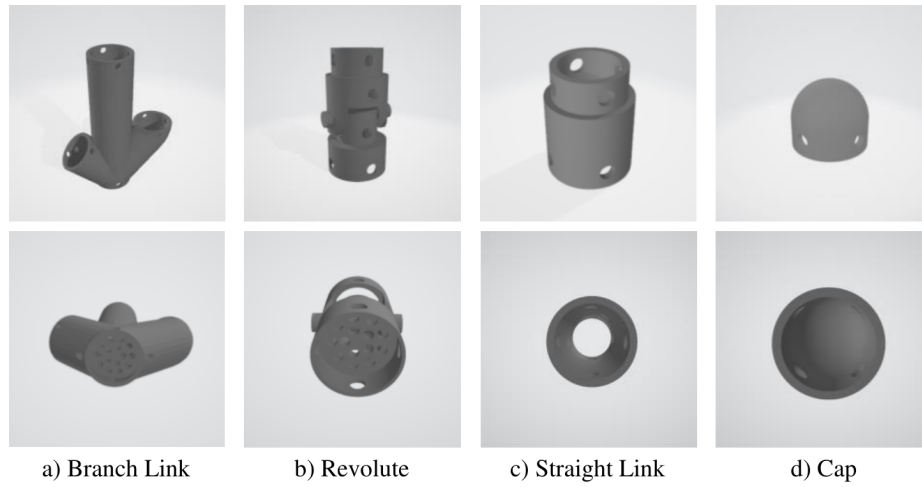
Fig. A. CAD for (a) branch link, (b) revolute, (c) straight link, and (d) cap modules.
