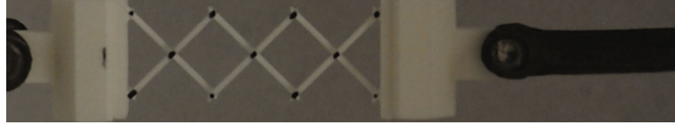
Fig. 3 Mini pantographic lattice in the testing machine
