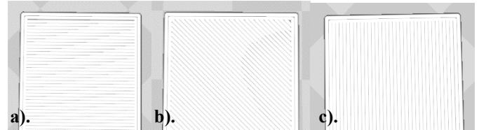
Figure 4. Printing angles: a). 0°; b). 45°; c) 90°.
