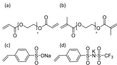
**Figure 1.** Monomers used in ionomer fabrication (a) PEGDA, (b) PEGDMA, (c) NaSS, and (d) KSTFSI.
