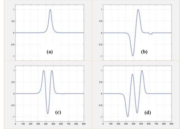
Fig. 4. Modified Hermite pulses in time domain (a) MHP0, (b) MHP1, (c) MHP2, and (d) MHP3.
