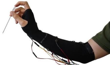
Fig. 1: 3D Vibrotactile Sleeve.
