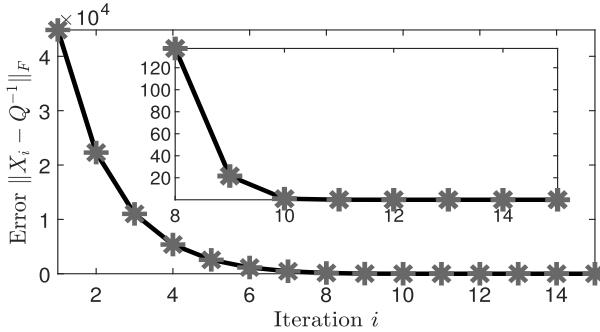
Fig. 2. Evolution of the error norm  $\|X_i - Q^{-1}\|_F$ ,  $i \in \mathbb{N}$ .
