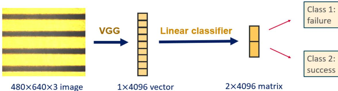
**FIGURE 4:** VGG NEURAL NETWORK SYSTEM FOR FAILURE RESULT DETECTION
