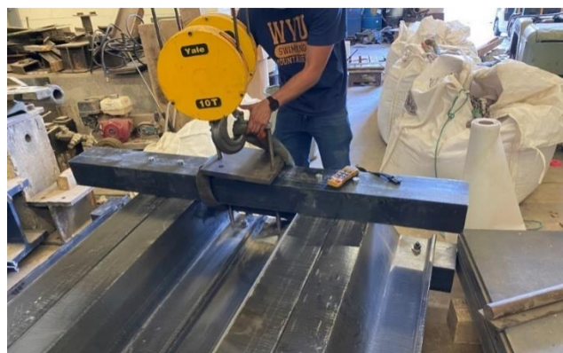
Fig. 7. Sheet pile test specimen.
