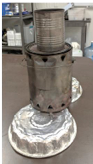
Fig. 2. Top lit updraft (TLUD) biochar production unit.
