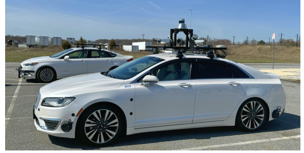
Figure 2. Hardware setup for AV data collection.
