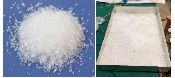
Fig. 4. The phase change material, \text{Na}_2\text{SO}_4 \cdot 10\text{H}_2\text{O} .
